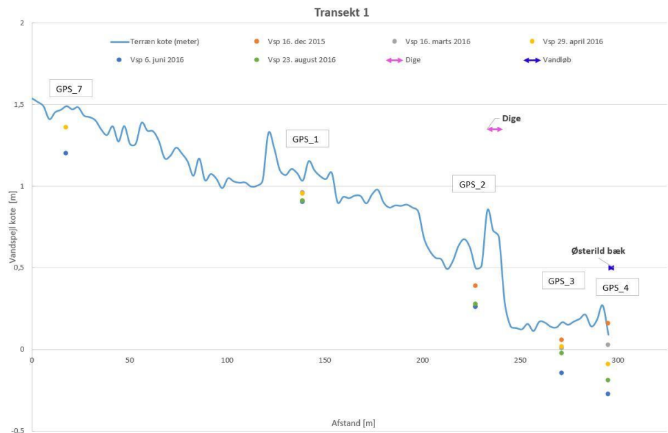
Figur 23, Øverst: Transektter og pejlepunkter (GPS) i projektområdet. Nederst: terrænkote med vandstandsmålinger fra pejlepunkter nord og syd for diget (lyserød markering).
